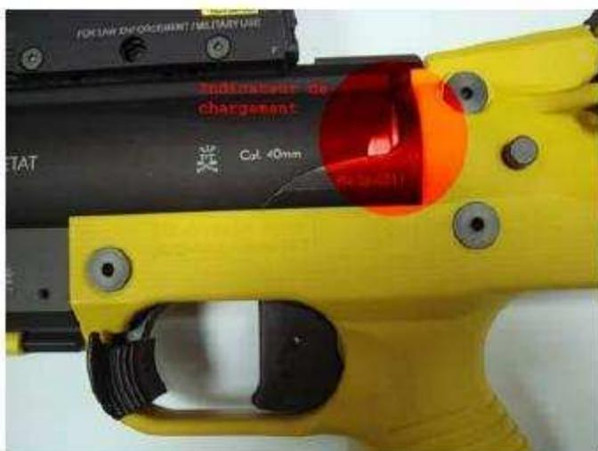
Contrôler visuellement le chargement au moyen de l'indicateur de chargement.
