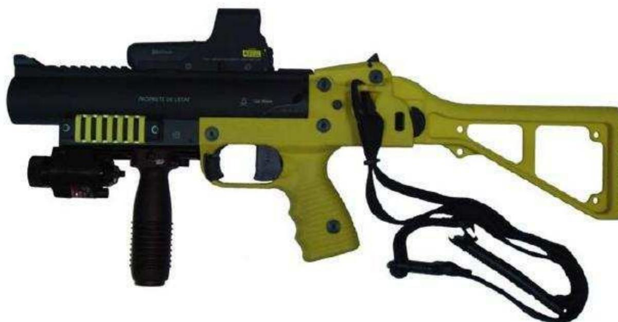
Lanceur 40X46mm avec accessoires (grip vertical, module lampe/laser).
